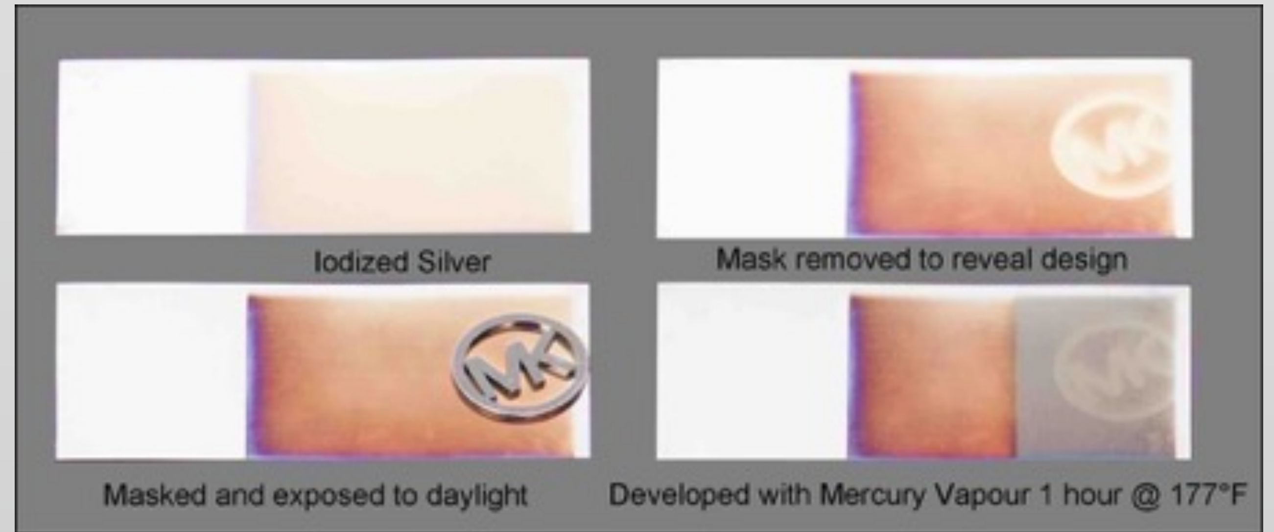
DagTest 1-14-2016. Mercury vapour reversal of a visible negative image.
